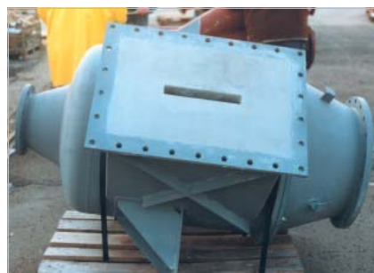
Ciclone de gás quente desenvolvido para temperaturas de 1 000 °C
