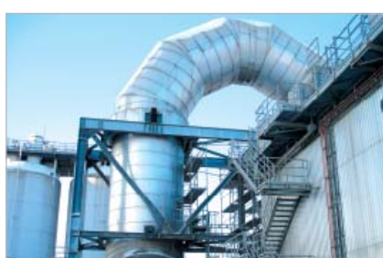
Tubo de transporte de pó de clinker em uma planta de cimento alemã
