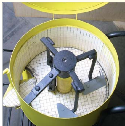
Tanque de um misturador na Kalenborn com proteção antidesgaste
