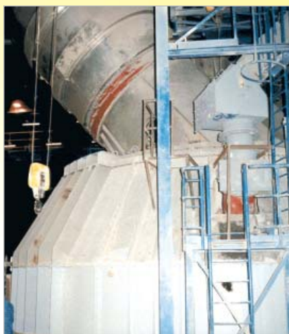
Revestimento de um moinho de farinha crua em uma planta de cimento
